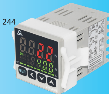
244 48 x 48 мм электронный контроллер с двойным дисплеем, ВКЛ-ВЫКЛ и PID автонастройка, несколько датчиков, релейные и SSR выходы
