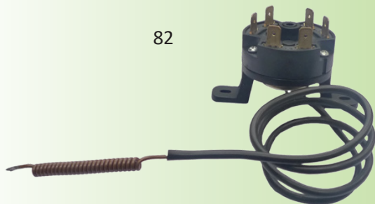
82 Трехполюсный термостат высокого предела с ручным сбросом, отказоустойчивый, фиксированная настройка, диапазон температур до 170°C
